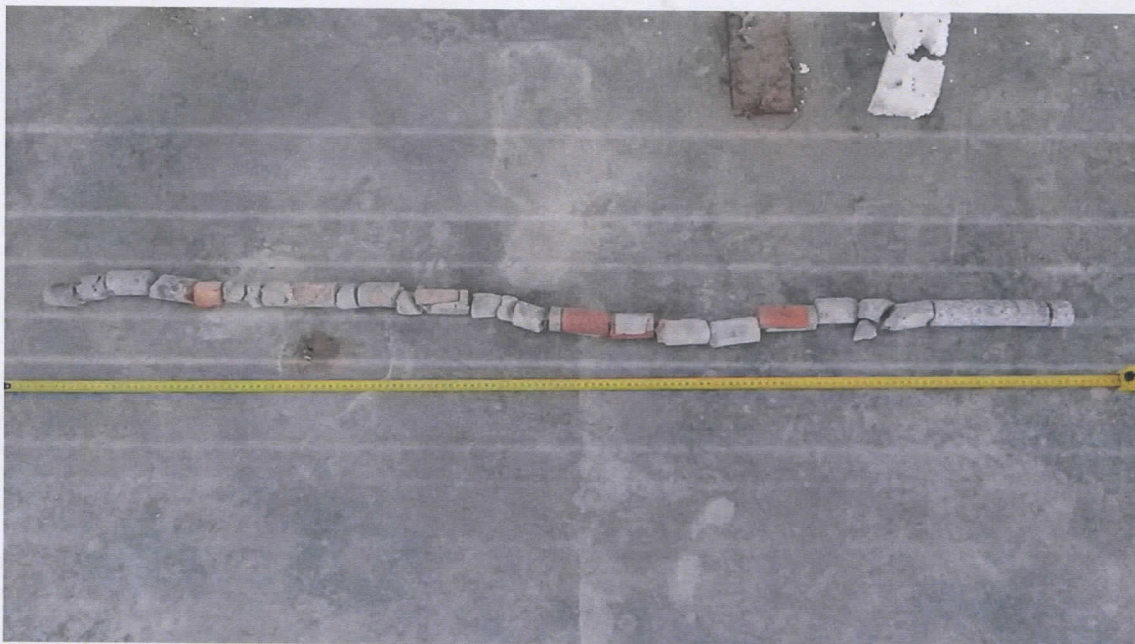
Fot. 1. Fotografia ilustrująca wzmocnienie podbudowy posadzki w części południowej. (dł. rdzenie ok. 140cm).
