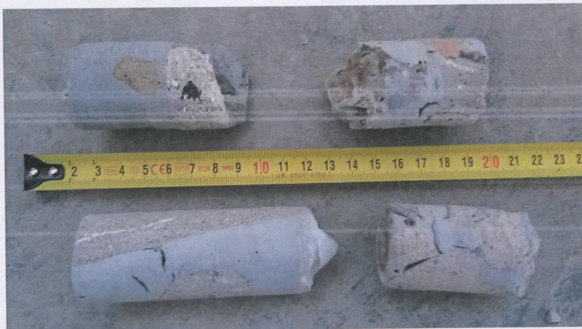
Fot. 4. Fotografia ilustrująca uzupełnienie iniektem rozluźnień pomiędzy fragmentami nasypu.
