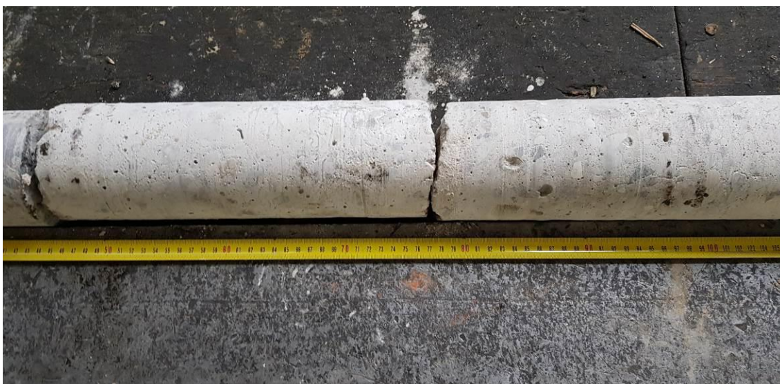
Fot. 2. Widok rdzenia dla przewiertu w lokalizacji nr 1 – środkowa część rdzenia fundamentu.
