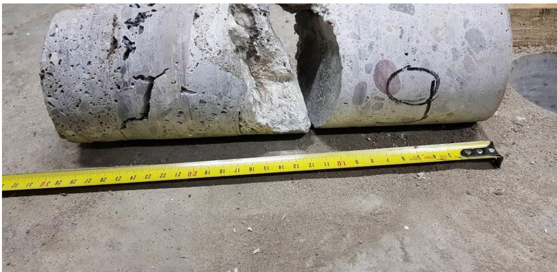
Fot. 14. Widok rdzenia dla przewiertu posadzki w lokalizacji nr 9.
