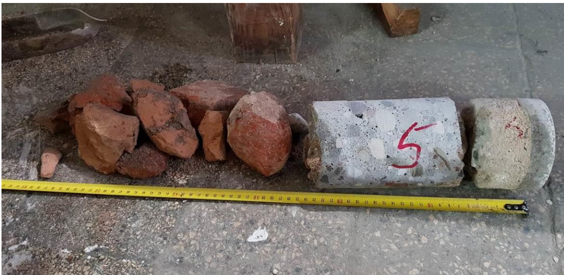
Fot. 10. Widok rdzenia dla przewiertu posadzki w lokalizacji nr 5.
