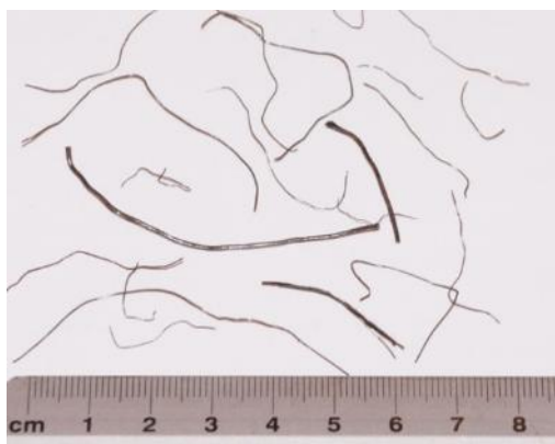
Fot 12. Włókna oczyszczone RTSF-A1
