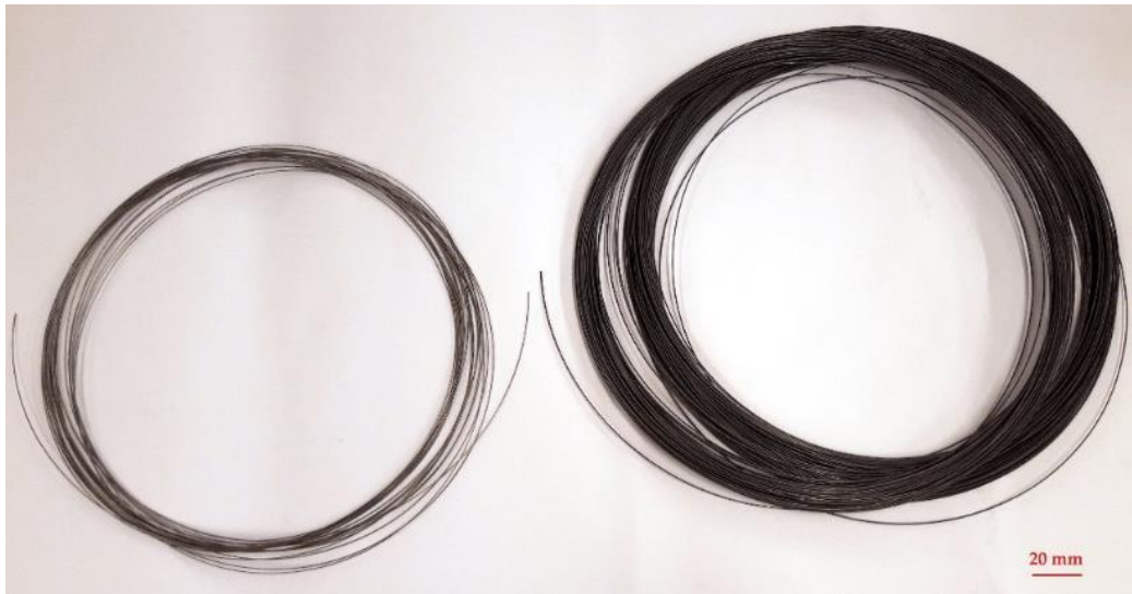
Fot 36. Druty MSF do badania przyczepności (MSF-1 po prawej, MSF-2 po lewej)
