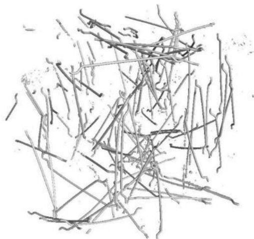
Fot 81. Obraz wygenerowany z danych pozyskanych techniką tomografii. Włókna MSF w ilości 40 kg/m 3
