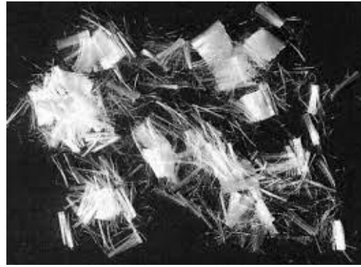
Fot 5. Przykłady mikrowłókien polimerowych pojedyncze klasy Ia [162,170]
