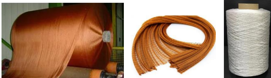
Fot 1. Przykłady kordu tekstylnego w oponie (poliester, nylon) [78–80]
