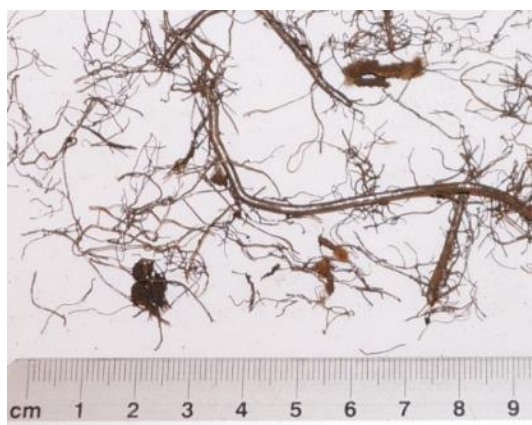
Fot 16. Włókna RTSF-D – metoda cieplna
