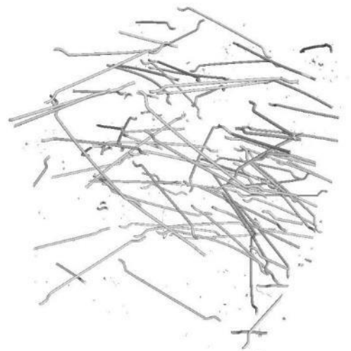
Fot 77. Obraz wygenerowany z danych pozyskanych techniką tomografii. Włókna MSF w ilości 20 kg/m 3
