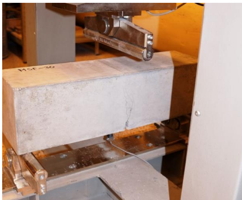
Fot 35. Betonowa belka z włóknami po badaniu wytrzymałości na rozciąganie przy zginaniu w układzie trójpunktowego zginania
