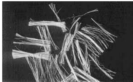
Fot 6. Przykłady mikrowłókien polimerowych fibrylowane klasy Ib [162,170]
