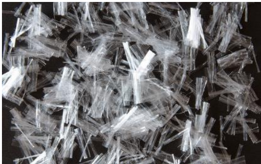
Fot 6. Przykłady mikrowłókien polimerowych fibrylowane klasy Ib [162,170]
