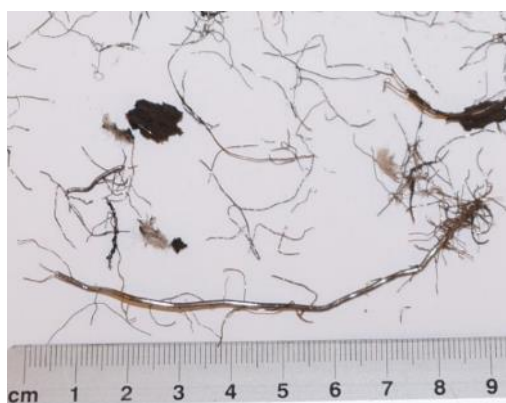
Fot 14. Włókna RTSF-B – metoda tarcia
