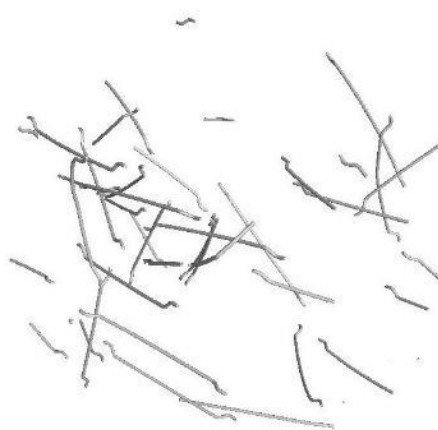
Fot 75. Obraz wygenerowany z danych pozyskanych techniką tomografii. Włókna MSF w ilości 10 kg/m 3
