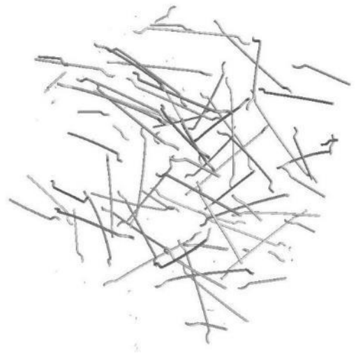
Fot 77. Obraz wygenerowany z danych pozyskanych techniką tomografii. Włókna MSF w ilości 20 kg/m 3
