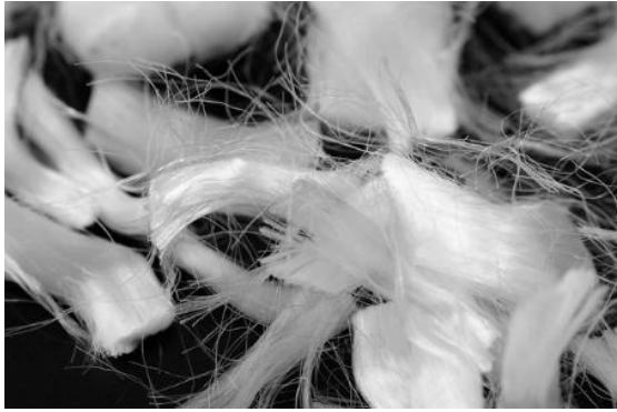
Fot 5. Przykłady mikrowłókien polimerowych pojedyncze klasy Ia [162,170]
