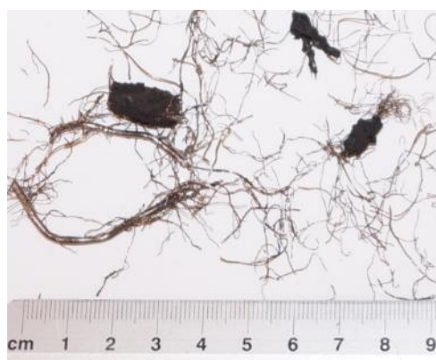
Fot 15. Włókna RTSF-C – metoda mechaniczna
