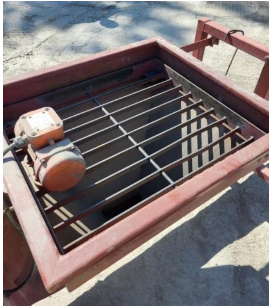
Fot 85. System dozowania włókien stalowych do betonowozu
