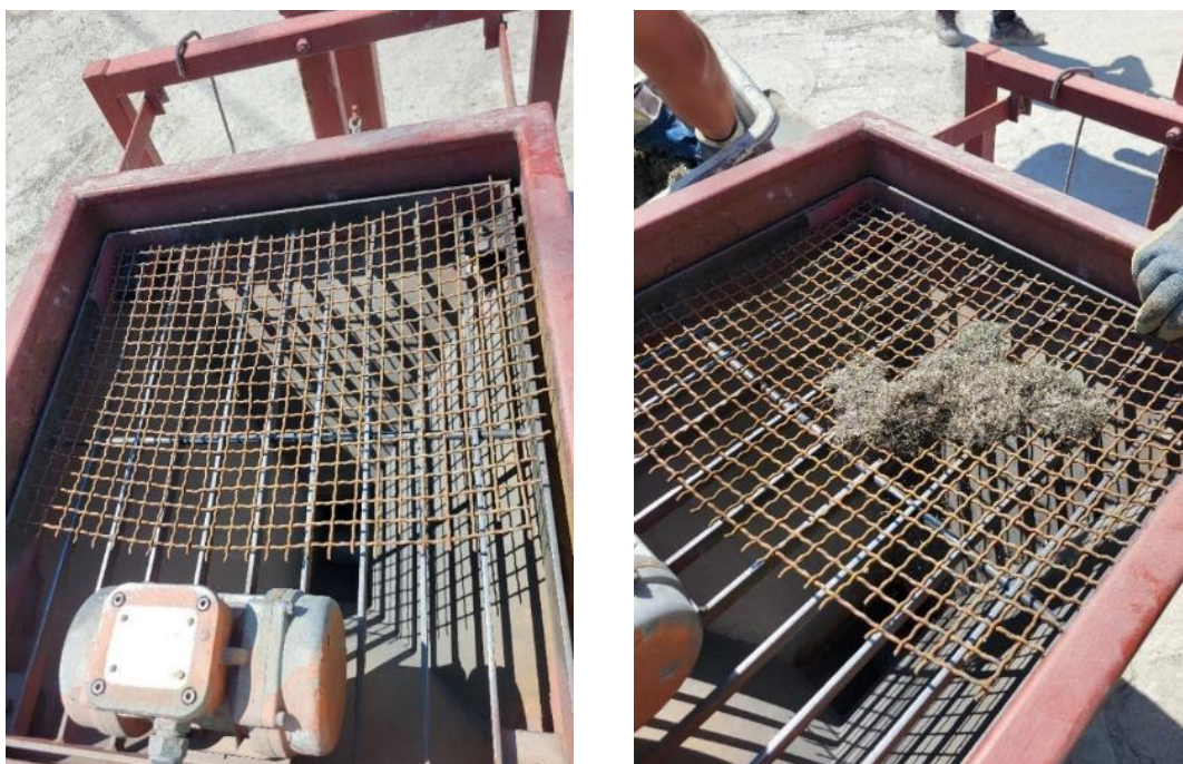
Fot 88. Sposób dozowania włókien RTSF za pomocą dostosowanej wstrzeliwarki.
