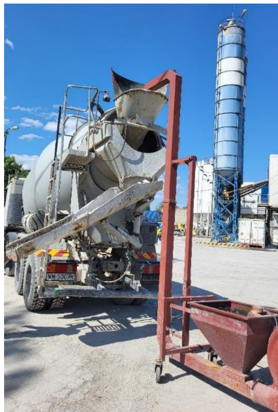
Fot 87. System dozujący włókna stalowe do betonowozu
