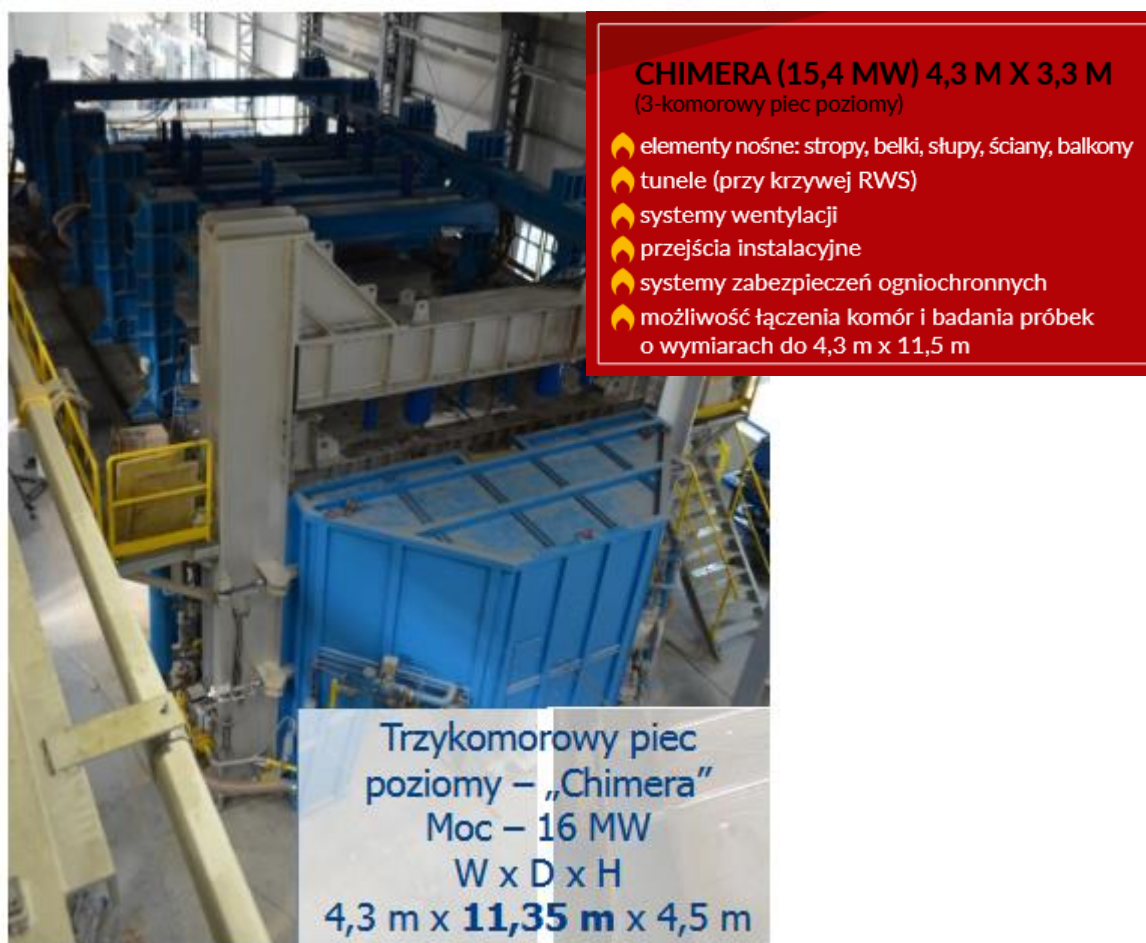
Rys. 1 Stanowisko do badań odporności ogniowej elementów konstrukcyjnych pionowych i poziomych. Uzyskane wyniki odpowiadają rzeczywistej odporności ogniowej elementu badanego i zazwyczaj są korzystniejsze od wyników otrzymanych na drodze obliczeniowej.
