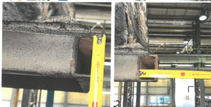
Rama dolna profile RP60x40x4 i RK 40x40x4 wraz z linkami #3-4mm podtrzymującymi tkaninę
